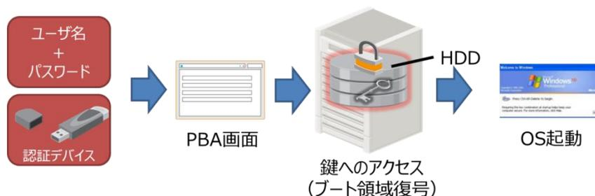
図4 . HDD暗号化動作概要
